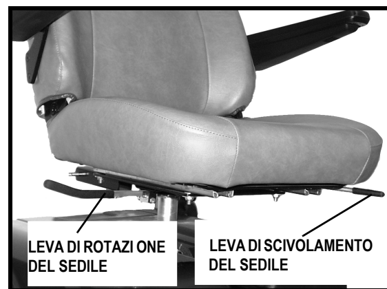
Figura 13. Regolazione di scivolamento del sedile
